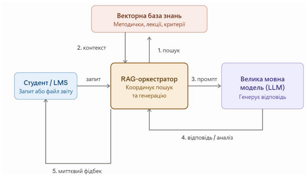
Рисунок 1 – Архітектура віртуального асистента викладача на основі технології RAG
