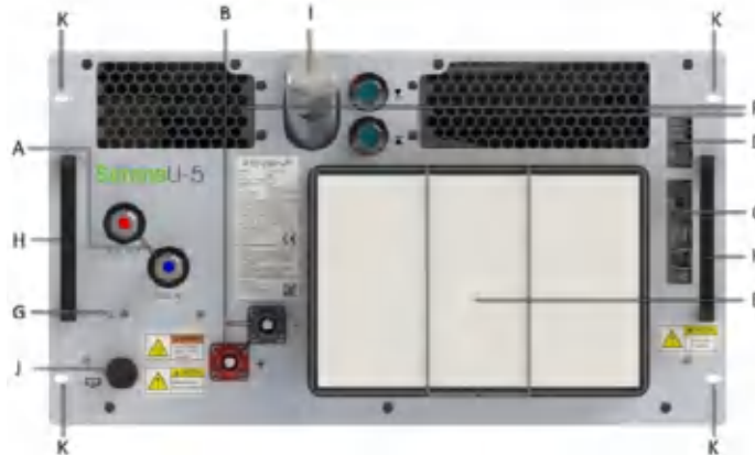
Рис. 1. Вид спереду паливного елемента (А - подача та повернення палива, В - вхід/вихід живлення, С - панель підключення для входу/виходу керування, D - індикатор стану, Е - катодний повітрязабірний фільтр, F - забір охолоджувального повітря, G - захисне заземлення, Н - ручки для переміщення паливного елемента на полицю стелажа (стійку), I - заповнення та індикатор охолоджуючої рідини, J - злив охолоджувальної рідини, К - отвори для кріплення).
