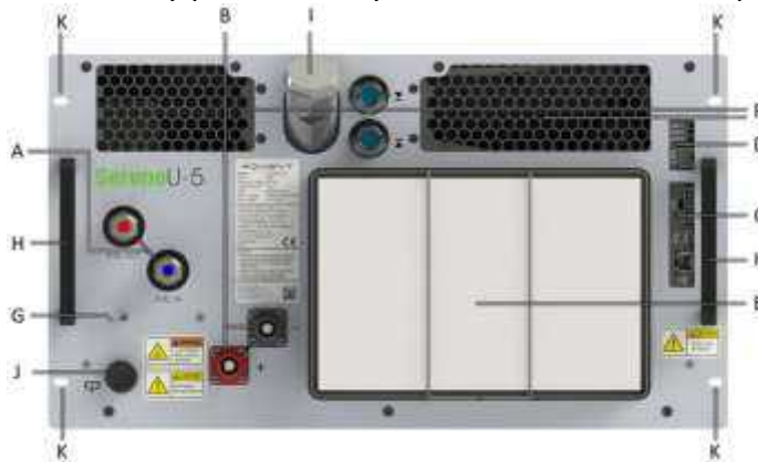
Рис. 1. Вид спереду паливного елемента (А – подача та повернення палива, В – вхід/вихід живлення, С - панель підключення для входу/виходу керування, D - індикатор стану, Е - катодний повітрязабірний фільтр, F - забір охолоджувального повітря, G - захисне заземлення, H - ручки для переміщення паливного елемента на полицю стелажа (стійку), I - заповнення та індикатор охолоджуючої рідини, J - злив охолоджувальної рідини, К - отвори для кріплення).
