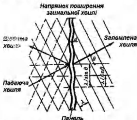
Рисунок 6.4 – Схема збудження згинальних хвиль в конструкції
