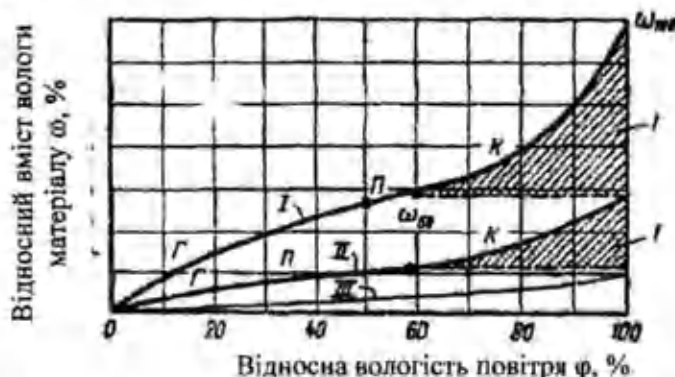
Рисунок 4.2 — Ізотерми сорбції води для характерних груп будівельних матеріалів: I — матеріали із змочуваною поверхнею пір і капілярів і присутністю осмотично зв'язаної води; II — з проміжними властивостями: I — кількість води, що характеризує вологоємність матеріалу при його зволоженні в межах від початкової (рівноважної) вологості до максимальної сорбційної; III — з незмочуваною (гідрофобною) поверхнею
