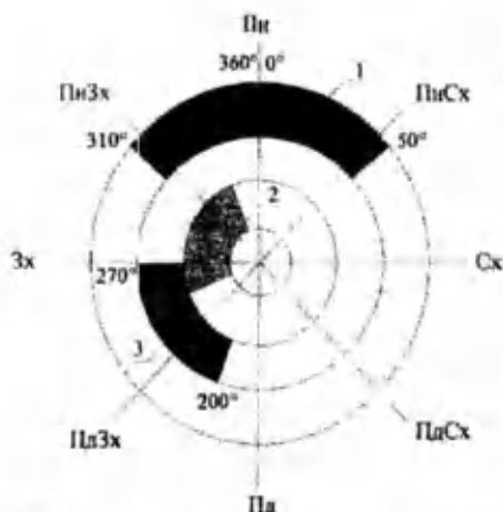
Рисунок 1.12 – Оцінка сторін горизонту по комплексу кліматичних чинників для м. Києва: 1 - неприпустима орієнтація при односторонньому розташуванні житлових кімнат квартири; 2 - несприятлива з умов вітроохолодження; 3 - небажана орієнтація з умови перегріву приміщень
