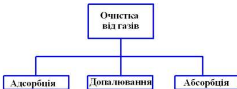
Рисунок 2 – Методи видалення газових складових з викидів
