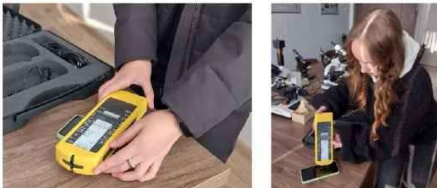
Рисунок 1 – Вимірювання електричної та магнітної складових приладом NFA- 1000
