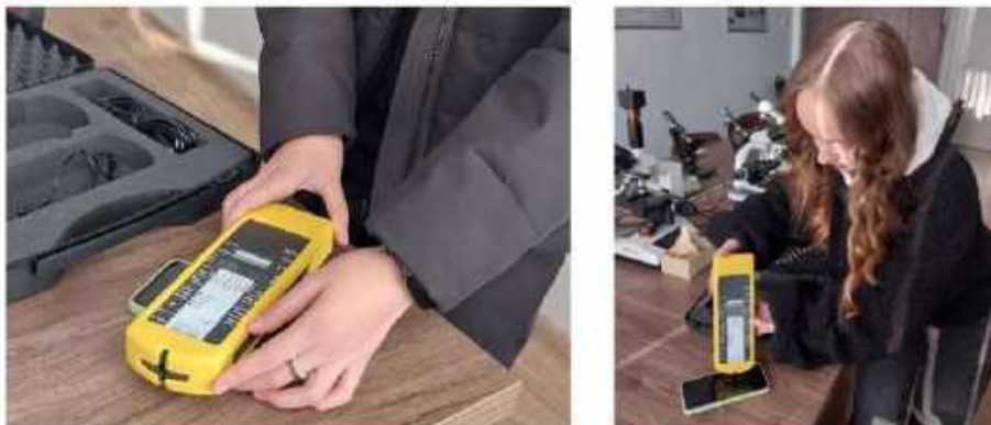
Рисунок 1 – Вимірювання електричної та магнітної складових приладом NFA- 1000
