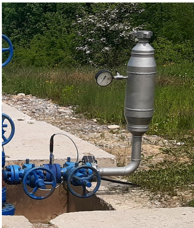
Рисунок 1.10 - Варіант підключення АСП при подаванні ПАР в затрубний простір свердловини
