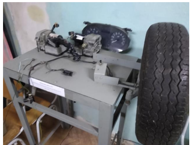
Стенд з системою активної безпеки Опель Вектра
