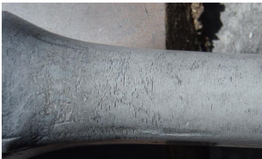
Рисунок 3 – Тріщини втоми, утворені в тілі штанг після випробувань при змінному напруженні \sigma=140 МПа
