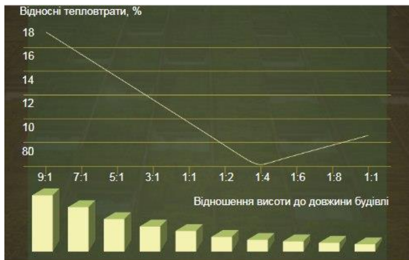
Рисунок 2 – Схема залежності тепловтрат будівлі (споруди) від її форми та відношення площі поверхні до об'єму
