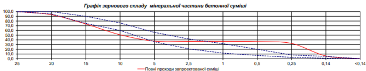
Рисунок 3 – Таблиця складу суміші класу міцності бетону В10 рухомості Р4 та графік зернового складу мінеральної частини бетонної суміші
