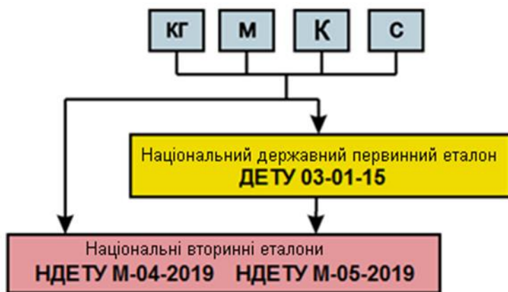
Рисунок 1 – Схема простежуваності національних еталонів до одиниць системи СІ
