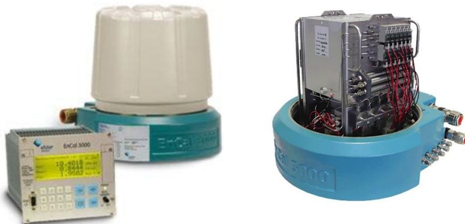
Рисунок 1.20. Хроматограф газовий Encal 3000 HCDP в зборі і зі знятою кришкою
