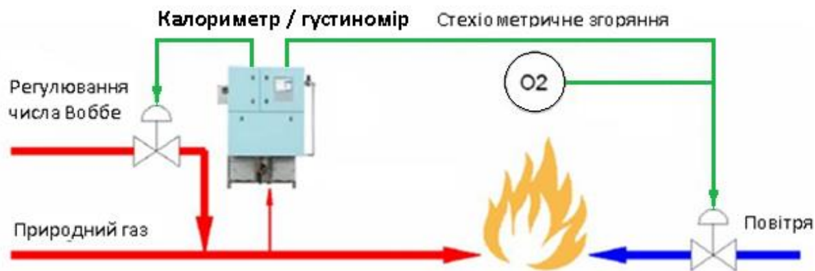
Рисунок 4.12 – Схема вимірювання та регулювання числа Воббе на основі визначення теплоти згоряння та / або густини газу
