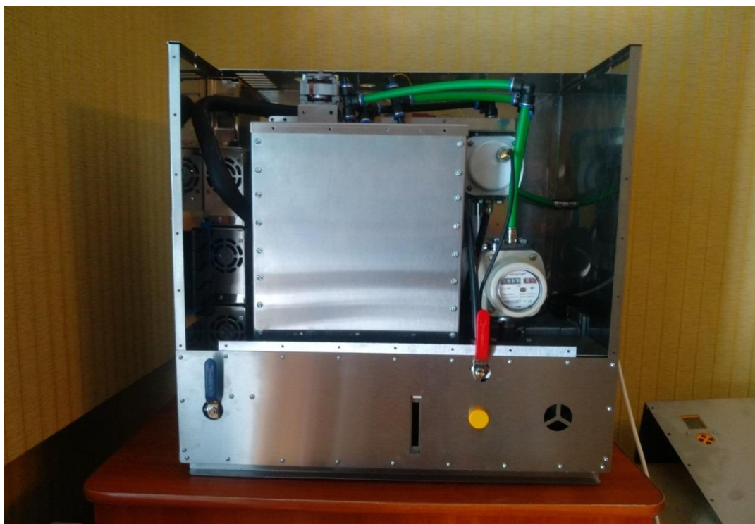
Рисунок 3.22 – Аналізатор енергетичних характеристик газу зі знятою передньою стінкою
