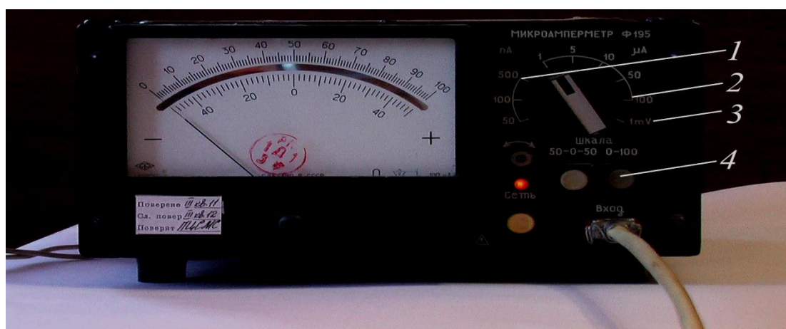
Рисунок Б.5 – Мікроамперметр Ф 195: 1 – діапазон вимірювань у наноамперах; 2 – діапазон вимірювань у мікроамперах; 3 – діапазон вимірювань у міліамперах; 4 – перемикач режимів шкали
