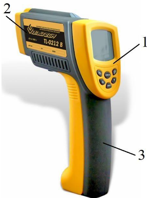
Рисунок Б.4 – Безконтактний термометр фірми «Балтех»: 1 – приймач енергії інфрачервоного випромінювання; 2 – табло термометра; 3 – ручка приладу
