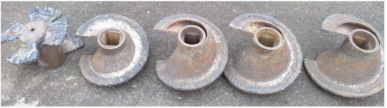
Рисунок 5.18 – Загальний вигляд секцій шнеків для виготовлення будівельної кераміки після відновлення
