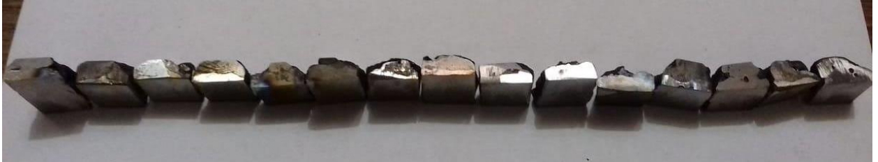
Рисунок 2.5 – Взірці наплавлені розробленими електродами
