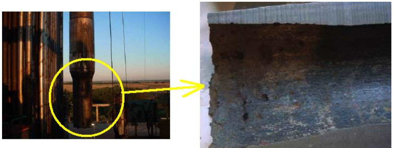
Рисунок 1.2 – Фото бурильної труби, що зазнала втомного руйнування по тілу
