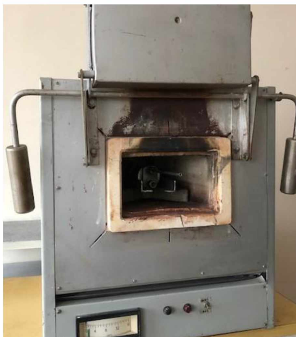
Рисунок 5.4 – Розгерметизація установки і охолодження реактора
