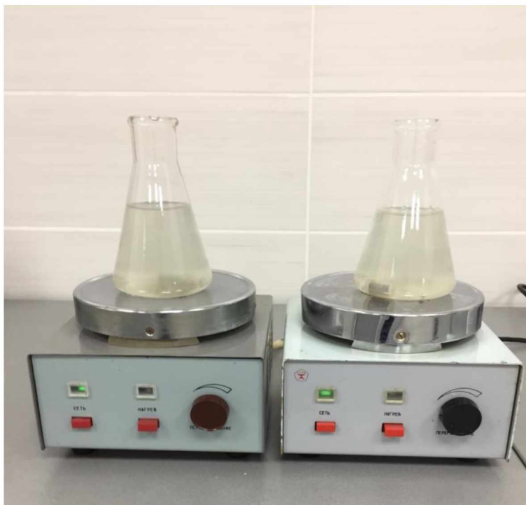
Рисунок 2.5 – Експериментальний процес дослідження динаміки сорбції іонів купруму і мангану на магнітній мішалці
