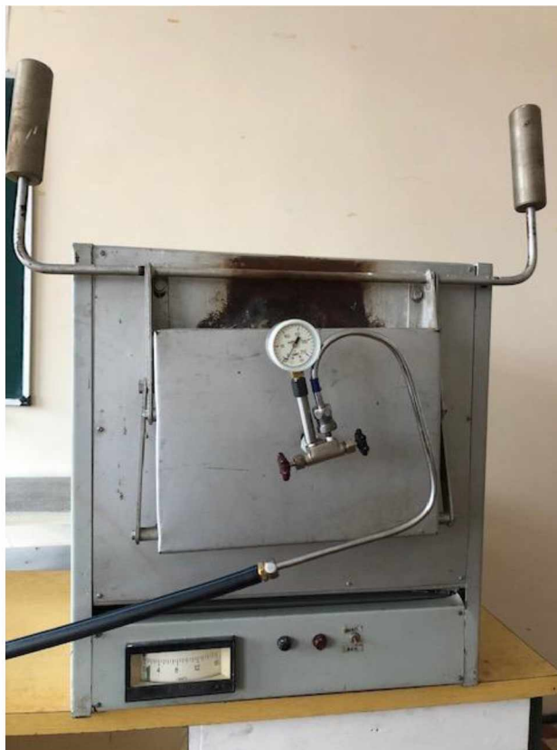
Рисунок 2.6 – Пристрій для отримання біосорбенту
