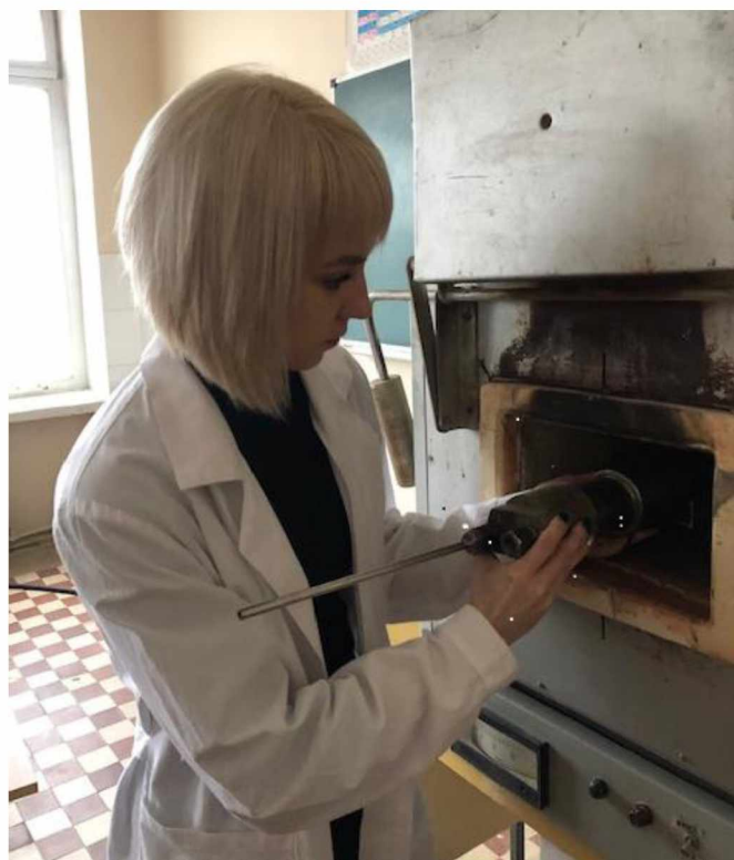
Рисунок 5.2 – Завантаження металевого реактора в установку
