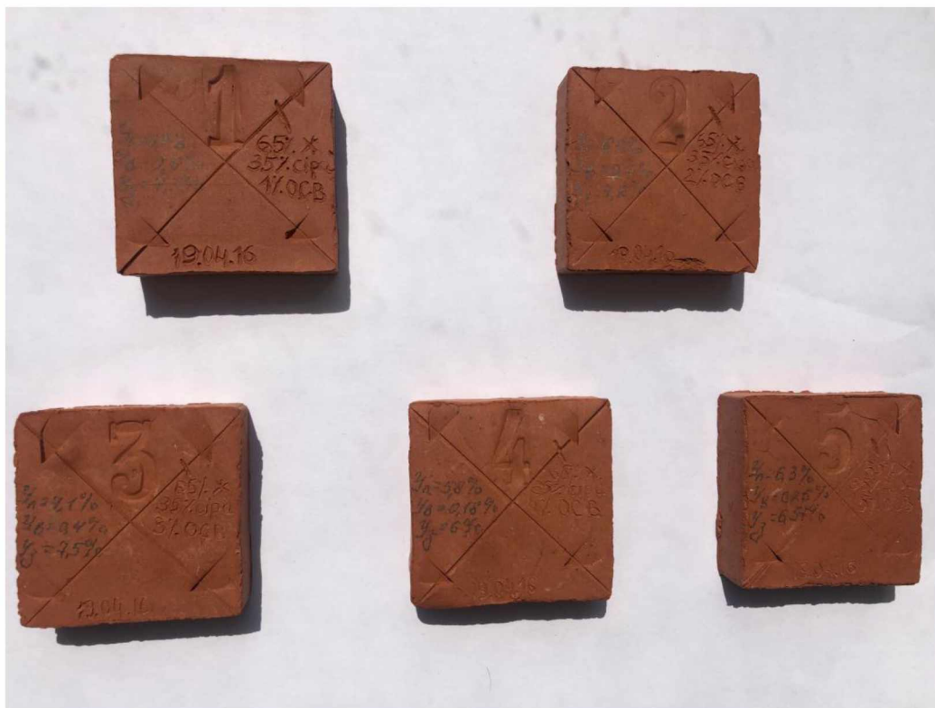
Рисунок 5.1 – Зразки цегли повнотілої рядової (шихта №1 та модифікуюча добавка)
