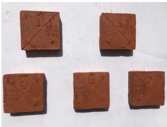
Рис. 8. Зразки цегли повнотілої рядової з модифікуючою добавкою
