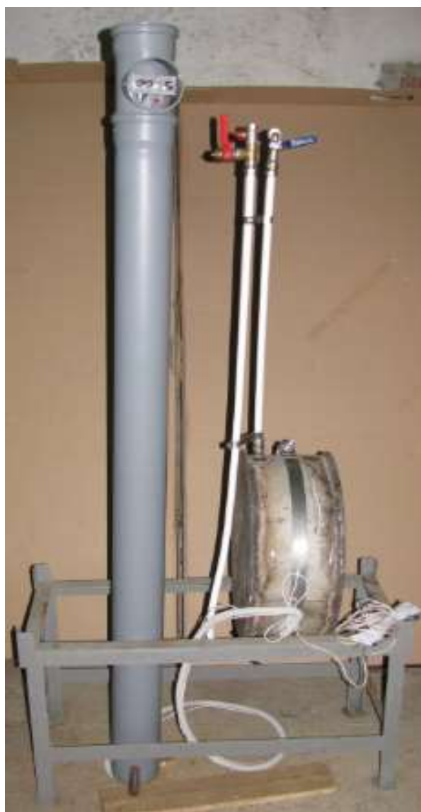
Рисунок 4.10 – Система моніторингу накопичення рідини в порожнині трубопроводу
