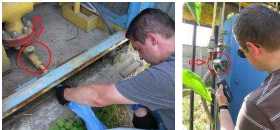
Рисунок 5.5 - Виявлення нетехнологічного витоку природного газу на елементах обладнання АГНКС: а) дренаж замірного вузла; б) індикаторний пристрій одоризації газу.
