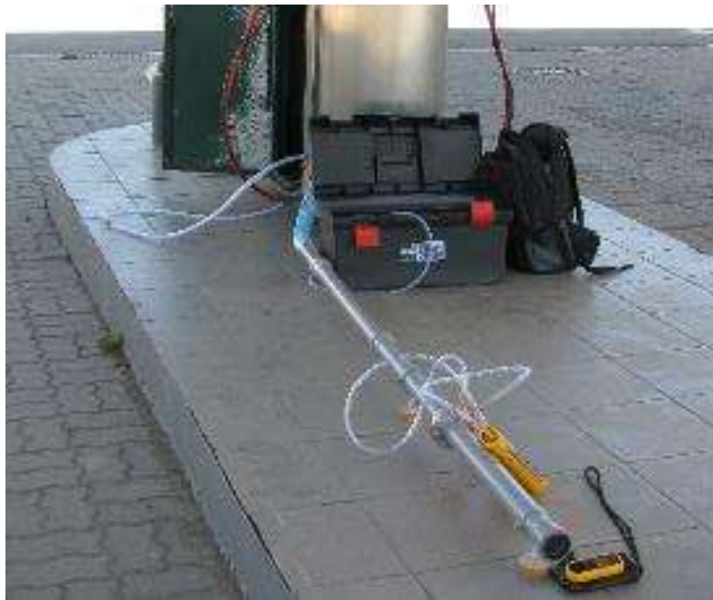
Рисунок 4.12 - Установка для контролю величини витоків
