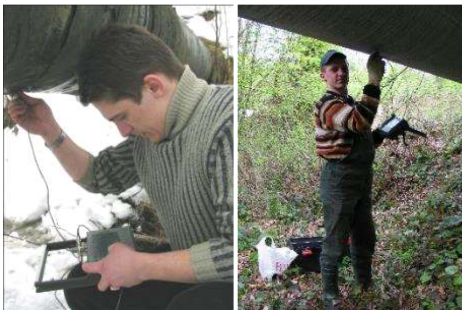
Рисунок 5.6 - Промислова апробація системи для виявлення та вимірювання рівня рідини в порожнинах газопроводів
