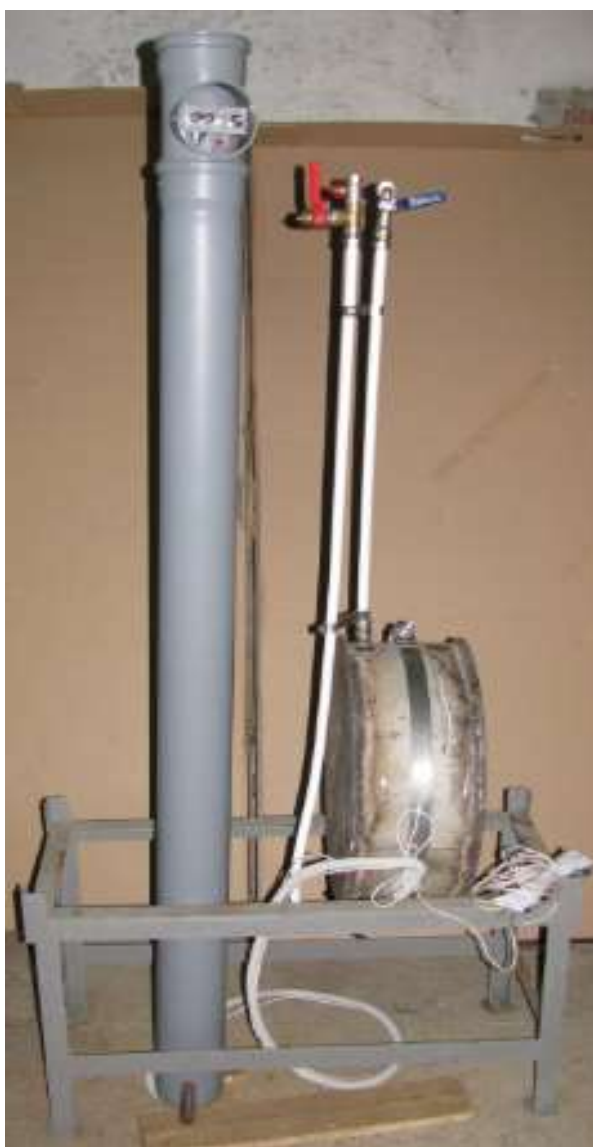
Рисунок 4.10 – Система моніторингу накопичення рідини в порожнині трубопроводу
