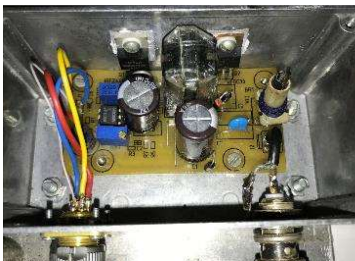
Рисунок 4.9 – Генераторний блок приладу для вимірювання якісних характеристик природного газу.
