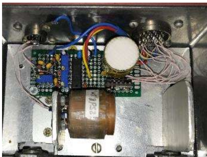
Рисунок 4.8 – Блок підсилення та інверсії, сумування та інтегрування ехо-сигналу.
