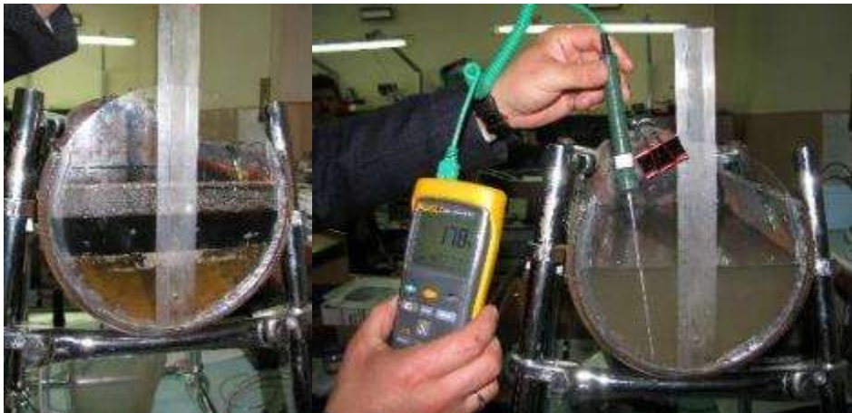
Рисунок 3.5 – Лабораторні дослідження удосконаленого методу вимірювання рівня нетехнологічних скупчень в порожнині трубопроводу
