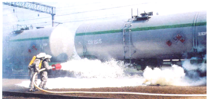
Локалізація розливу НХР шляхом накриття шаром повітряно-механічної піни
