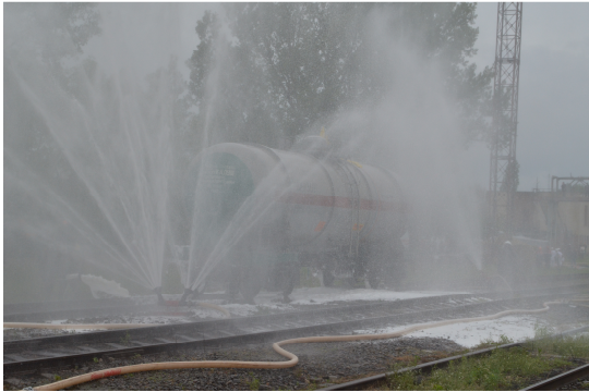
Локалізація (осадження) хмари НХР за допомогою водяної завіси
