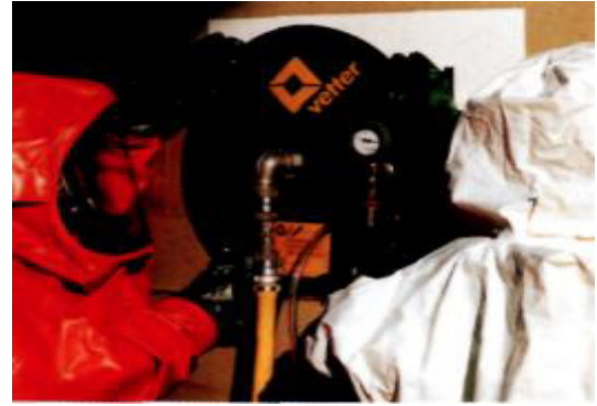
Ліквідація витоку НХР шляхом перекачування НХР з пошкоджених ємностей (трубопроводів) в резервні ємності
