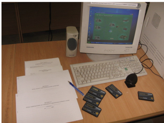
Робоче місце для видачі і збирання індивідуальних дозиметрів та обліку індивідуальних доз опромінення (система АСІДК)
