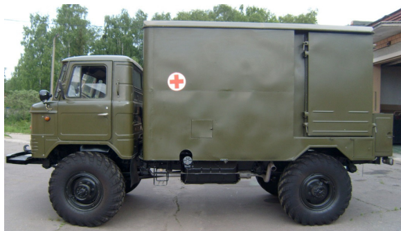
Дезінфекційно-душовий автомобіль ДДА-66 у похідному вигляді
