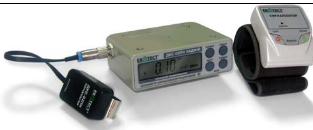
Рис. 4.2. Дозиметр-сигналізатор пошуковий ДКС-02ПН "КАДМІЙ"
