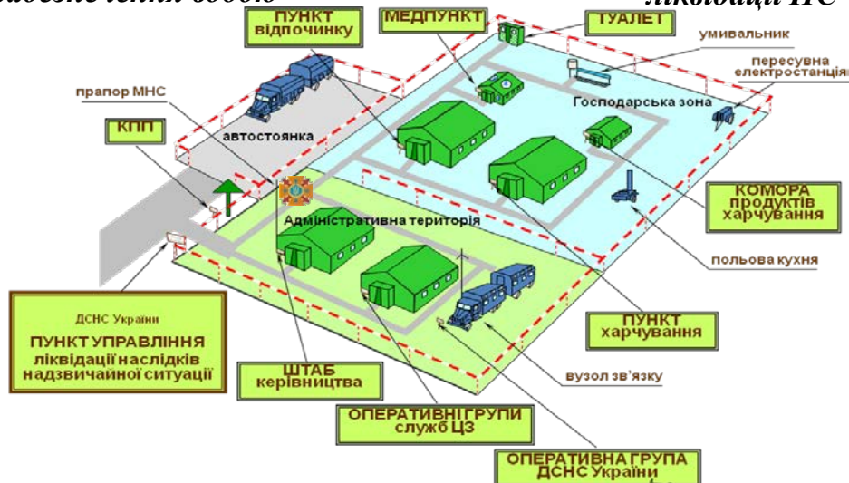
Рис. 5.7. Схема обладнання пересувного пункту управління
