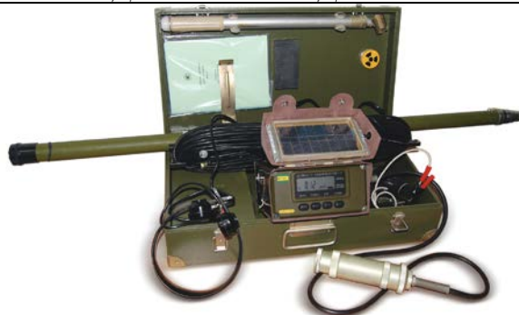
Рис. 4.3. Дозиметр-радіометр універсальний МКС-У
